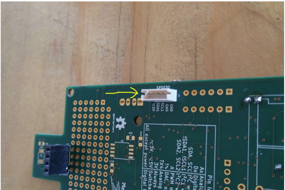
Foto 13: de orientatie van het stekkertje voor de fijnstofmeter
